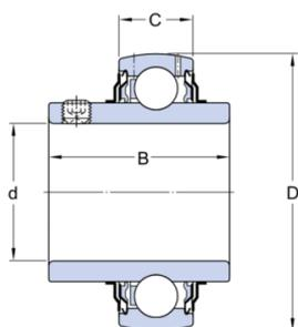
Les roulements Y SKF, généralement appelés roulements « insert », sont des roulements rigides à billes protégés des séries 62 et 63 qui présentent une surface extérieure sphérique convexe. Ces roulements sont fabriqués dans des tailles et des séries variées et sont disponibles avec une bague intérieure standard ou débordante d'un côté ou des deux côtés.
