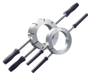
La bague de chauffage en aluminium est conçue pour le démontage des bagues intérieures des roulements à rouleaux cylindriques. Des bagues de chauffage sont disponibles pour toutes les dimensions de roulements des séries NU, NJ et NUP, c'est-à-dire des roulements sans épaulements ou avec un seul épaulement sur la bague intérieure. En standard, les bagues sont disponibles pour les tailles de roulements suivantes : 204 à 252, 304 à 340, 406 à 430.
