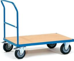
Par exemple: Système modulable. Ensemble mécano-soudé, revêtement époxy bleu RAL 5007, plateau en mélaminé surface effet hêtre. 2 roues pivotantes et 2 roues fixes, moyeu à roulement à rouleaux, freins sur roues pivotantes conformément à la Norme 1757-3 [Sécurité des chariots de manutention].
