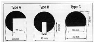
Bordures antichocs de couleur jaune/noir en caoutchouc mousse souple et solide, longueur 1m. Fixation par collage.
