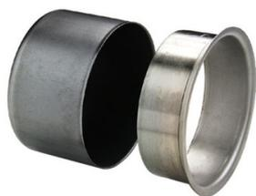
Eri-sleeve est une pièce d'usure de précision exécutée en acier inoxydable AISI 304 chromé dur, servant à la réparation d'axes usés. Il convient uniquement pour des bagues d'étanchéité avec lèvre en caoutchouc. L'eri-sleeve possède une surface de friction idéale de 0,4 à 0,8 Ra. Ne demande aucun usinage avant et/ou après montage.
