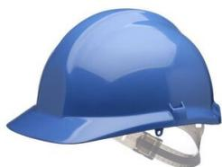
Un casque de sécurité à usage général. Il est équipé d'un berceau en térylène à 6 points avec réglage par glissement, et d'un bandeau en nylon brossé. Flexibilité maximale grâce à la possibilité de choisir entre une coque réduite et une coque complète.
