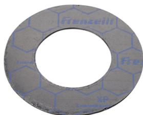
Le joint NOVAPHIT SSTC XP se présente avec deux faces grises traitées anti-adhérentes. Fabriqué à partir de graphite expansé (99%) renforcé par une tôle d'accrochage en métal déployé en acier inoxydable 316L.
