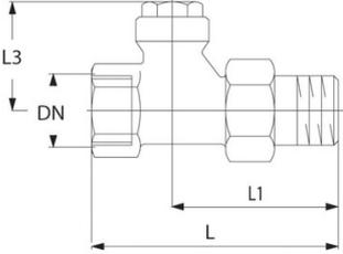
**Matériau d'écrou mobile:** Laiton
