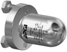
La série UBS20 d'ADCA est un purgeur de vapeur bimétallique en acier sans entretien, qui convient comme traçeur de vapeur et comme spirale de réservoir dans l'industrie pétrochimique, entre autres, dans des endroits où un sous-refroidissement considérable du condensat ne peut pas causer de dommages. Ce purgeur bimétallique est rapidement interchangeable grâce à son "connecteur pivotant" universel.
