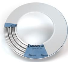
Les joints jaquettes avec âme et insert métallique ondulé sont des joints constitués d'une âme élastique recouverte d'une enveloppe en PTFE et un insert inox ondulé.
