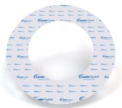
Le Delta Flon MG® est constitué de PTFE modifié chargé d'une fibre inorganique spéciale, de couleur crème sur ses 2 faces, avec marquage bleu. Il présente d'excellentes caractéristiques mécaniques (meilleure résistance au fluage, à la compression et à l'usure) qui lui confèrent une grande capacité d'étanchéité, complétant les excellentes propriétés du PTFE face aux milieux les plus agressifs.
