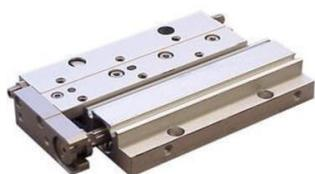
La MXF est une table linéaire à profil étroit qui utilise un guide rigide qui peut être monté en parallèle avec un vérin pneumatique. L'actionneur est équipé de trous d'emplacement pour un montage facile et rapide lors du changement des outils ou des appareils fixes. La hauteur de la table linéaire MXF est de 54 à 67% inférieure à celle de la série MXS.
