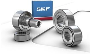
SKF Stützrollen sind Nadel- bzw. Zylinderrollenlager mit einem dickwandigen Aussenring. Die Mantelfläche am Aussenring ist profiliert, was Kantenspannungen bei Verkippungen oder Schräglauf vermindert. Sie sind einbaufertig, mit Schmierfett befüllt und zur unmittelbaren Verwendung in allen Arten von Kurvengetrieben, Führungsbahnen, Förderanlagen usw. geeignet.
