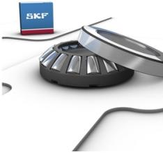
Axial-Pendelrollenlager haben besonders gestaltete Laufbahnen und asymmetrische Rollen. Sie können Axialbelastungen in einer Richtung aufnehmen aber auch Radialbelastungen bei gleichzeitig wirkenden Axialbelastungen. Die Belastungen werden schräg zur Lagerachse von einer Laufbahn auf die andere übertragen. Ein Bord an der Wellenscheibe führt die Rollen
