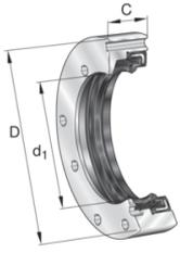
Dichtungsträger DRS werden an die Zwischenscheibe der Nadel-Axial-Zylinderrollenlager geschraubt und dort exakt zentriert. Sie dichten die Lager von der Außenseite her ab. Die Abdichtelemente werden als kompletter Bausatz geliefert und bestehen aus einem Dichtungsflansch mit integriertem Radial-Wellendichtring, einer Flanschdichtung und Zylinderschrauben mit Innensechskant zur Befestigung des Trägers an der Zwischenscheibe des Lagers.
