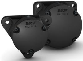
Die FNL-Flanschlagergehäuse sind konzipiert für die Einbauart "Lager auf Spannhülse und glatter Welle" mit 20 bis 100 mm Durchmesser und vorgesehen für den Einbau von Pendelkugellager der Reihen 12 K und 22 K, Pendelrollenlager der Reihe 222 K, CARB Toroidalrollenlager der Reihe C 22 K.
