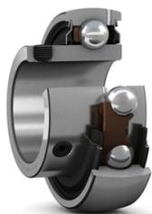
SKF Y-Lager, in der Norm werden sie Spannlager genannt, basieren auf abgedichteten Rillenkugellagern der Reihen 62 bzw. 63 mit kugelig ausgeführter Aussenringmantelfläche. Sie werden serienmässig in verschiedenen Baureihen und Grössen gefertigt. Sie haben entweder einen normalen, in der Hauptsache aber einen ein- bzw. beidseitig verbreiterten Innenring.
