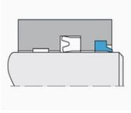
Der Abstreifer WRM ist ein einfachwirkender formvulkanisierter Elastomerabstreifer. Er besitzt am Außendurchmesser eine kammprofilierte Dichtfläche, die einen festen Sitz in der Nut gewährleistet. Der Abstreifer WRM lässt sich einfach in geschlossene Nuten montieren.
