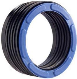
Mehrteiliger Merkel Dichtsatz zur Abdichtung von Kolbenstangen, bestehend aus einem Druckring, mindestens 3 Manschetten und einem Stützring. Die Merkel Dachmanschettensätze werden in 3 verschiedenen Ausführungen
