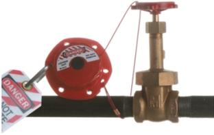
Die Mini-Kabelsperre ist perfekt für Trennschalter, kleine Schieber usw. geeignet. Durch den per Druckknopf zu bedienenden Selbstaufrollmechanismus kann das Kabel straff gespannt werden. Im Lieferumfang enthalten ist ein 2,4m langes Kabel aus armiertem Stahl oder Nylon, das einen festen Sitz an Ventilen und Hebeln ermöglicht. 6 Schlossbohrungen zum Aufnehmen der meisten Vorhängeschlossbügel und Haspen.
