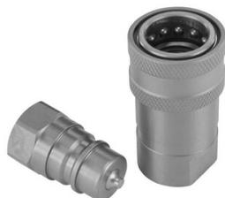
Steckkupplungen mit Kegelventil der Serie ID bestehen aus einem Kupplungsstecker und einer Kupplungsmuffe und dienen dazu, Rohr- und Schlauchleitungen schnell und einfach von Hand, also ohne Werkzeug, zu kuppeln und entkuppeln.
