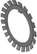
Sicherungsbleche sind einfache, haltbare und zuverlässige Sicherungselemente. Der innere Lappen des Sicherungsblechs greift in eine Nut in der Welle. Einer der äusseren Lappen wird zur Sicherung in eine Nut der Mutter umgebogen. Sicherungsbleche werden bei Wellenmuttern der Reihen KM und KML eingesetzt sowie bei Wellenmuttern in Zollabmessungen der Reihen N und AN.
