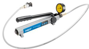
La pompe SKF 729124 est prévue principalement pour être utilisée avec les écrous hydrauliques SKF ≤ HMV 54E pour monter des roulements ou des composants là où une pression maximale de 100 MPa est requise.
