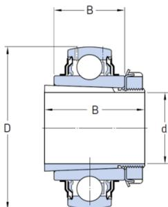
Les roulements Y SKF, généralement appelés roulements « insert », sont des roulements rigides à billes protégés des séries 62 et 63 qui présentent une surface extérieure sphérique convexe. Ces roulements sont fabriqués dans des tailles et des séries variées et sont disponibles avec une bague intérieure standard ou débordante d'un côté ou des deux côtés.
