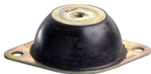
Support industriel type M, à basse fréquence propre. Ce support souple convient parfaitement pour l'isolation de groupes d'air conditionné, boîtiers de commande, instruments et appareils de mesure. Nombre de tours: à partir de 750 t/min. Livrable en 40 [A] ou 60 [B] shore A. Exécution en inox sur demande.
