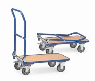
Par exemple: Chariots en tube d'acier, revêtement époxy avec plate-forme en mélaminé surface effet hêtre. Dossier de poussée rabattable sur la plate-forme. 2 roues pivotantes et 2 roues fixes à bandage caoutchouc, moyeu à roulement à rouleaux. Freins sur roues pivotantes.
