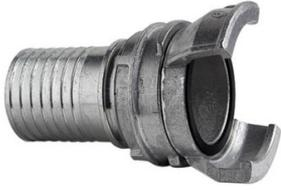
Demi-raccord symétrique Guillemin type GSG/RK. Raccord à douille cannelée et colerette avec verrou pour montage avec colliers et coquille serrage. Exécution: aluminium. Joint: NBR.
