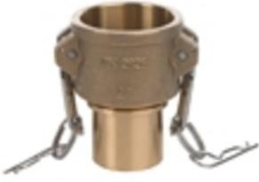
Raccord rapide Eritite type C suivant MIL-C-27.487 en laiton. Coupleur avec embout cfr DIN2817/EN14420 pour flexible. Joint en Buna-N. Poignée et goupille en inox, anneau en acier galvanisé.
