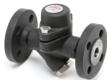
La série ADCA TH32YLC est un purgeur thermostatique en acier de faible capacité, équipé d'un filtre intégré et d'une excellente purge. Il est spécialement conçu pour des applications avec des équipements de process tels que les chaufferies, les stérilisateur, les équipements alimentaires, chimiques et de lavage.
