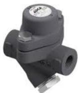
Les purgeurs de condensats bimétalliques en acier conviennent pour les traceurs de vapeur et les spirales de réservoir dans l'industrie pétrochimique, et dans d'autres endroits où la surfusion considérable du condensat ne peut pas occasionner de dégâts.
