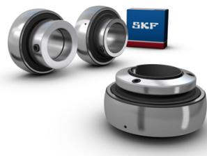
SKF Y-Lager, in der Norm werden sie Spannlager genannt, basieren auf abgedichteten Rillenkugellagern der Reihen 62 bzw. 63 mit kugelig ausgeführter Aussenringmantelfläche. Sie werden serienmässig in verschiedenen Baureihen und Grössen gefertigt. Sie haben entweder einen normalen, in der Hauptsache aber einen ein- bzw. beidseitig verbreiterten Innenring.
