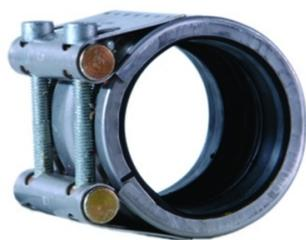
Nicht zugfeste Rohrkupplungen für alle Rohrmaterialien. Je nach Öffnung unterstützen die Kupplungen einen Biegewinkel von 2° bis 5° und eine axiale Bewegung von 5mm. Bei der Montage müssen die Verschlusschrauben mit dem korrekten Drehmoment angezogen werden. Das Drehmoment ist auf der Kupplung angegeben.
