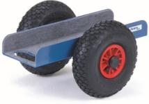
Par exemple: Construction en tôle d'acier, revêtement époxy bleu RAL 5007. Support en U recouvert de feutre de protection. Largeur support : 150 mm , largeur totale : 380 mm. 2 roues à bandage caoutchouc ou gonflables.
