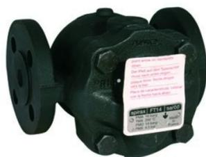
Le purgeur de condensat à flotteur en fonte ductile type FT14 est adapté à une utilisation universelle. Le mécanisme du flotteur assure un écoulement direct de grandes quantités de condensat et le purgeur automatique assure l'évacuation des gaz non condensables. La conception unique permet un réglage facile de la direction de montage en retirant le boîtier sphérique et en le tournant dans la direction souhaitée.
