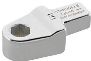
6 pans femelle avec bague-ressort de pression (modèle déposé en Allemagne). Les embouts s'insèrent facilement, sont bien verrouillés et se retirent sans difficultés, même les six pans à rainure large (Forme E, DIN 3126/ISO 1173).
