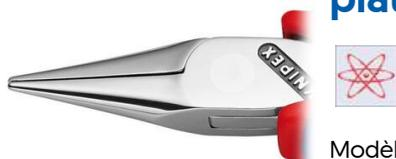
Modèle : DIN ISO 9655. En acier à outils spécial trempé à l'huile et revenu. Tête polie miroir. Articulation entrepassée de précision et sans jeu et double ressort pratiquement exempt de friction et imperdable. Surfaces de préhension rectifiées lisses. Branches à gaine synthétique multicomposants.
