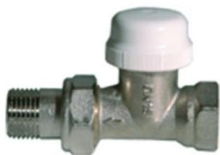
**Caractéristiques****Type:** 2671**Modèle:** Droit**Matériau du boîtier:** Laiton**Revêtement du surface:** Nickelé**Connexion du radiateur:** Fileté [BSPP]**Raccord de tube:** Taraudé [BSPP]**Classe de pression:** PN10**Type de commande:** Commande manuelle**Préprogrammable:** Non**Matériau du capot:** Plastique blanc**Matière de l'axe:** Laiton**Matière de l'étanchéité primaire à l'axe:** EPDM**Température maximum de service:** 120 °C**Application**
