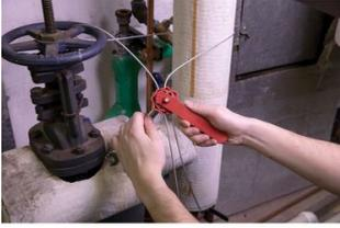
Condamnez efficacement de nombreux types de points d'isolation difficiles à sécuriser, notamment les vannes, les poignées et les dispositifs grand format, grâce à cette solution de condamnation par câble polyvalente.
