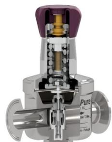
La série P130J d'ADCAPURE est un réducteur de pression à action directe, commandé par membrane pour des gaz purs, et équipé d'une soupape de sûreté. Ce réducteur de pression haut de gamme se caractérise par une conception compacte, des joints conformes à la norme FDA / USP Class VI et un bouton de réglage non inclinable.
