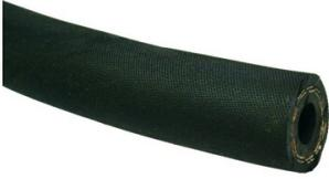
Tuyaux flexibles à monter par l'utilisateur, pour les raccords enfichables le tube dispose d'une gorge de retenue à son extrémités. L'augmentation de volume à env. 40 bar s'élève à entre 1 - 1.4 cm<sup>3</sup>/m. Tuyau perbunan, résistant aux huiles minérales, deux tresses en fibre synthétique.
