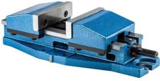
Étau à auto-centrage – mécanique Modèle : structure basse et solide, corps en fonte spéciale. Les mors de serrage interchangeables et réversibles sont trempés, rectifiés et brunis, un mors est lisse, l'autre mors à prismes longitudinaux et transversaux. Mors à réglage mécanique, manivelle pour couvrir la totalité de la plage de serrage. Broche cachée, protégée de la poussière et des copeaux. Auto-centreur, les guidages latéraux permettent un alignement facile et exact de l'étau.
