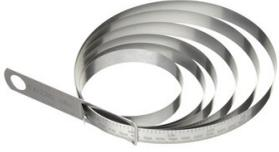
Mit dem Circometer können Sie den Durchmesser oder den Umfang Ihres O-Rings auf 1 / 10mm genau bestimmen. Maagtechnic hat 3 Typen mit unterschiedlichen Messbereichen: 1: 20-300mm 2: 300-700mm 3: 700-1100mm
