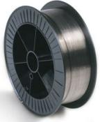
Massivdrahtelektrode für das Schutzgasschweißen un- und niedriglegierter Stähle unter CO<sub>2</sub> oder Mischgas. Spritzerarmer Werkstoffübergang im Kurz- und Sprühlichtbogen. Hohe Lichtbogenstabilität auch bei hohen Schweißstromstärken. Große stahlseitige Anwendungspalette; besonders geeignet für höherfeste Stähle im Behälter-, Konstruktions-, Fahrzeug- und Schiffbau.
