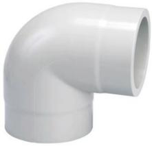
**Merkmale****Serie:** 108**Material:** PP-H**Anschluss:** Schweißende**Geeignet für die Elektrofusion Armatur:** Nein**Winkel des Bogens:** 90 °**Min. Dauertemperatur (Medium):** 0 °C**Max. Dauertemperatur (Medium):** 80 °C
