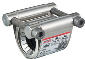
Zugfeste Rohrkupplung für Metallrohre. Zusätzliche Gewichtseinsparung einer leichteren Ausführung. Je nach Öffnung unterstützen die Kupplungen einen Biegewinkel von 2° bis 5°. Bei der Montage müssen die Verschlusschrauben mit dem korrekten Drehmoment angezogen werden. Das erforderliche Drehmoment ist auf der Kupplung angegeben.
