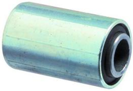
Diese vielseitig anwendbaren Federelemente bestehen aus zwei zylindrischen Stahlhülsen, zwischen die mit hoher Pressung ein Natur-Gummitteil montiert ist. Durch die Vorspannung kann die Innenbüchse gegenüber der Aussenbüchse einer sehr grossen Verdrehung ausgesetzt werden, ohne dass sich der Gummitteil verschiebt.
