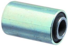
Diese vielseitig anwendbaren Federelemente bestehen aus zwei zylindrischen Stahlhülsen, zwischen die mit hoher Pressung ein Natur-Gummiteil montiert ist. Durch die Vorspannung kann die Innenbüchse gegenüber der Aussenbüchse einer sehr grossen Verdrehung ausgesetzt werden, ohne dass sich der Gummiteil verschiebt.
