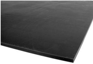
Das NBR-Elastomer, auch unter dem Namen Nitril bekannt, ist der geeignete Werkstoff für den Kontakt mit Mineralölen und Kraftstoffen. NBR hat mittlere bis gute mechanische Eigenschaften, welche jedoch, wie auch die Beständigkeit, stark vom ACN-Gehalt abhängig sind. NBR-Elastomere sind nicht witterungs- und ozonbeständig, ausgenommen hydriertes NBR.
