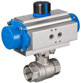
Das druckluftbetriebene 2-Wege-Kugelventil ist nach folgenden Grundprinzipien konfiguriert: pneumatischer Steuerdruck bei 6&nbsp;bar, Medium ist Wasser, Mediumtemperatur beträgt maximal 100&nbsp;°C, Kugelventil wird täglich mindestens ein paar Mal betätigt, Antriebsaufbau gemäß Eriks-Standard.
