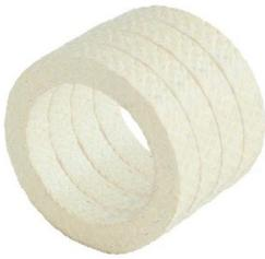
Diese Packung wird aus hochverschleißfestem Aramidgarn mit einer speziellen PTFE-Imprägnierung und einem universellen, stabilen Einlaufgleitmittel hergestellt. Ihre hohe Beständigkeit gegen Abrieb sowie gegen Temperaturschwankungen und unterschiedliche Chemikalien machen sie zu einer universellen Abdichtung für viele Industriebereiche.
